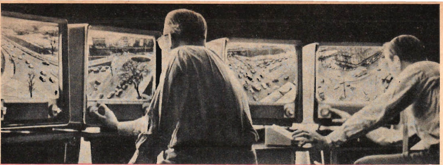
Så här såg det ut i en tysk "bildcentral" (ovan) under pågående prov med trafik-TV. Bilderna nedan visar t. h. en TV-fjärrkamera, som från ett höghus blickar ut över Plärrer-området i Nürnberg, och t. v. en av de riktsträlare som användes vid Nürnbergsförsöken och via vilken TV-bilden trådlöst skickades vidare till polisens trafikövervakningscentral.
