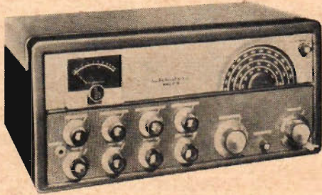
MODELL HT-30 är en sändare för den mer kräsne amatören. Frekvensområde: 80, 40, 20 och 10 meters banden. 21 rör. Alla kontroller sitter väl överskådligt på framsidan.
