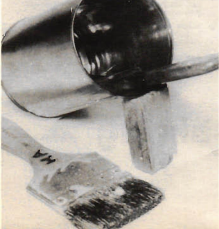
Ett billigt sätt att mjuka upp en pensel är att doppa den i en burk med litet lösning, ställd på kant och stödd av en träbit, som spikats i burken.
