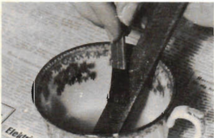
En rostig fil kan rengöras genom att den penslas med saltsyra. Det är viktigt att efteråt skölja den i vatten och sedan låta den torka i en trasa.
