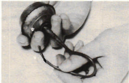
Har ni svårt att komma åt med oljekannan i t.ex. en modellmotor är det ett bra knep att förlänga pipen med hjälp av ett stycke cykelventil-gummi.
