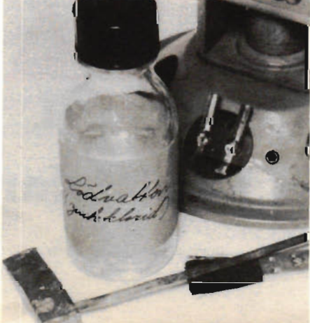
För den händige hobby-jobbaren bör det gå lätt att själv tillverka lödvatten. Det är bora att lösa litet zinkklorid i vatten och sedan är det klart.
