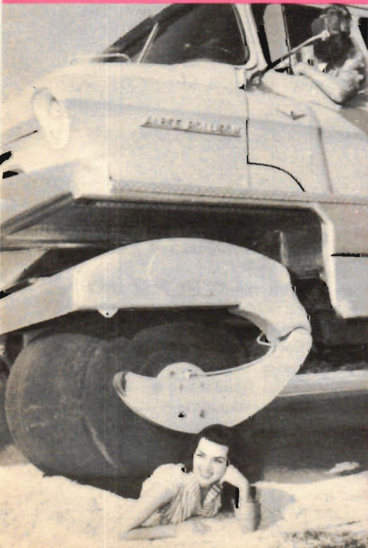
Här manglas 18-åriga Cindy O'Hara av en jättestor lastbil. Det är dock ingen fara, för den stora Algee Rolligon-vagnen har breda och mjuka kuddhjul, som "flyter ut" kring alla hinder på vägen.
