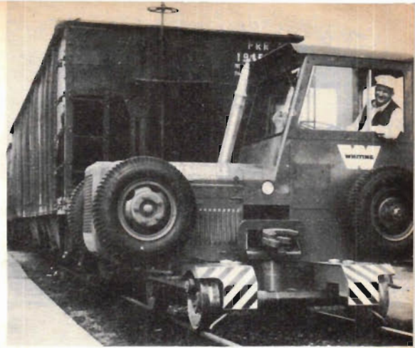
Trackmobile kallas åkdonet här ovan, som används för att dra eller skjuta på godsvagnar, som behöver flyttas inom bangårdsområdet. Om så behövs kan dessutom gummihjulen sänkas ner, varvid bilen kan köras på vanligt vis. Trackmobilen finns redan i arbete på ett par platser i USA.
