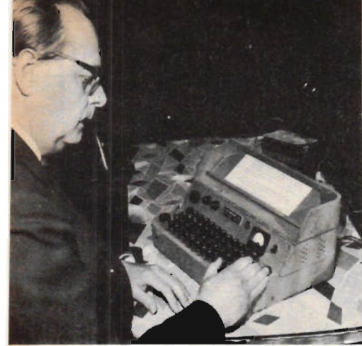
En "morskrivmaskin", som gör det möjligt för vem som helst att sända radiomeddelanden per telegrafi, har konstruerats av den norske ingenjören Leif Evensen. Apparaten väntas få stor betydelse t.ex. vid olyckstillfällen, där ingen utbildad radiotelegrafist för ögonblicket finns.
