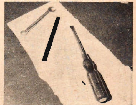
Tre enkla verktyg behövs — en fast nyckel för stoppmuttern, en skruvmejsel för att vrida den och ett bladmätt av den dimension som fabrikanten anger som ventilspelrum för motorn ifråga.
