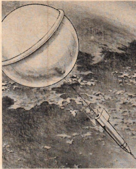
Här släpar ballongen efter raketen i lång wire, detta för att ge maximalt luftmotstånd. Ballongen ger även rymdraketen bättre stabilitet.
