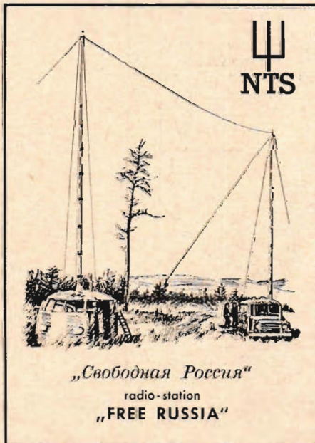
"Radio Fria Rysslands" verifikationskort visar en bild av sändaranläggningen, vilken är installerad i två skåpbilar. Antennen spänns mellan bilarna.
