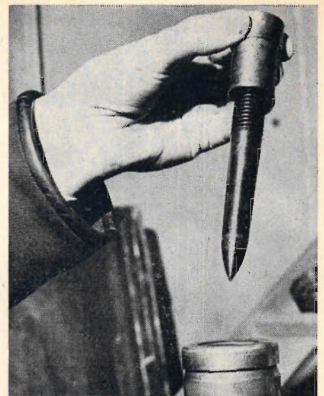
En hålbult laddas. Diametern är antingen \frac{3}{4} tum eller — som bulten på bilden — \frac{5}{8} tum. Den projektilliknande spetsen stöts bort sedan bulten skjuts in i plåten. Ytterdelen är försedd med gängor.
