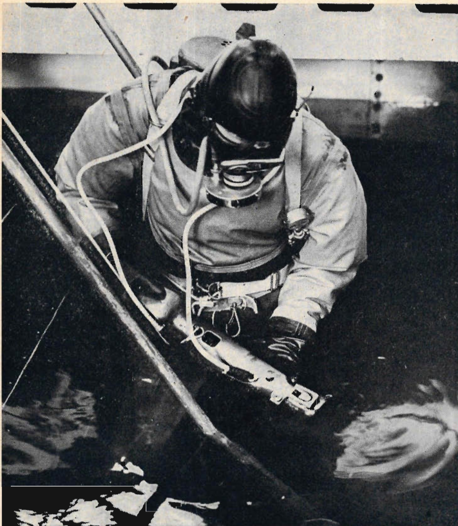
Skyddsdykaren är på väg ned i djupet med bultgeväret klargjort. En ubåt ligger manöveroduglig på botten och det gäller nu för honom att så snabbt som möjligt finna den del av ubåtsskrovet, som bäst lämpar sig för en attack med bultgeväret. Det är en svår uppgift att orientera sig i mörkret nere på botten.
