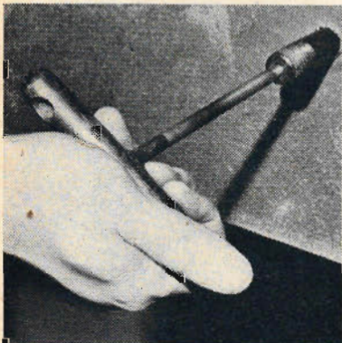
Sedan bulten skjutits in i plåten vrider man in en specialskruvmejsel med vars hjälp spetsen stöts in i det nödställda fartyget.
