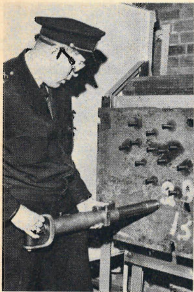
Bultgeväret visas här i läge för avfyring. Observera hålbultarna som tidigare skjutits in i fartygsplåten. Bilden är tagen på Marinens skyddstjänstskola utanför Stockholm.
