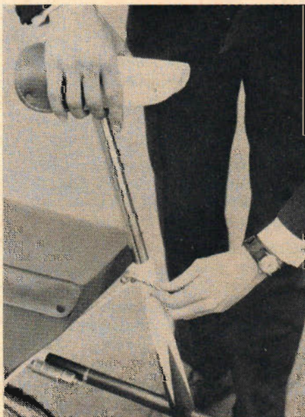
Sadeln kan lätt höjas och sänkas med hjälp av en liten sexkantnyckel. Det behövs bara en liten vridning och sadeln låses säkert i önskat läge.
