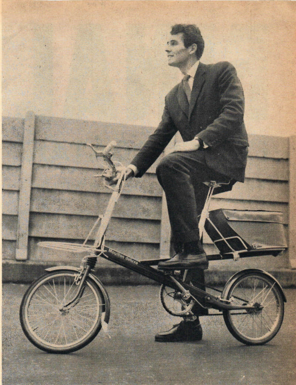
Moulton deluxe är inte lik andra cyklar. Här har man nämligen utnyttjat erfarenheterna från skotrar och bil-fjädring och resultatet har blivit en mjukt framglidande tvåhjuling. En effektiv fjädring gör att ojämnheter i vägbanan inte märks, och de små hjulen, som bara mäter 40 cm i diameter, ger en låg tyngdpunkt.
