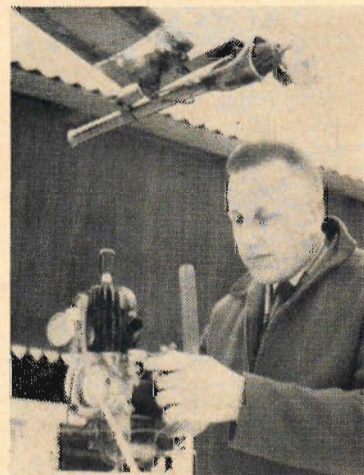
Rotornavet är en ganska komplicerad detalj (bilden t. v.). Rotorn har ledad upphängning och inställbar anfallsvinkel. T. h. visas mopedmotorn, som driver styrpropellern, samt en av de båda jetmotorerna.
