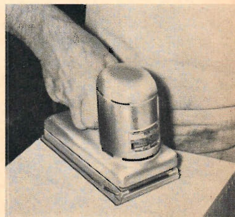
Den oscillerande sliptillsatsen är ett utmärkt tillbehör för fnputsning. Avverkningsförmågan är låg och tillsatsen lämpar sig inte för grövre arbeten.
