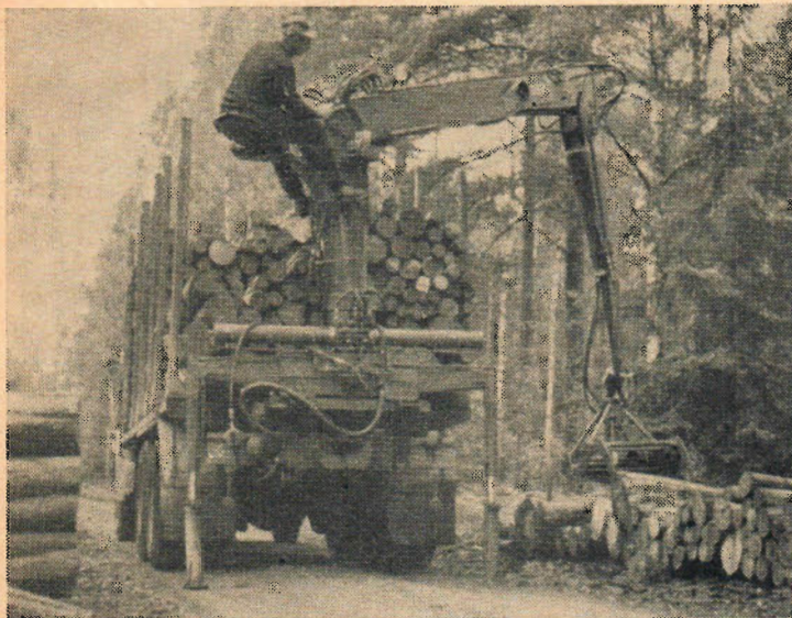
Den nya hydrauliska lyftapparaten har en kapacitet på 1 000 kilo vid fem meters armlängd. Den sköts helt av en man, vilken har alla regler inom bekvämt räckhåll.
