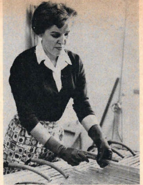
Det är noga med renligheten i neonskyltbranschen. Före och under bearbetningen tvättas därför rören noga i hett vatten och torkas med varmluft.
