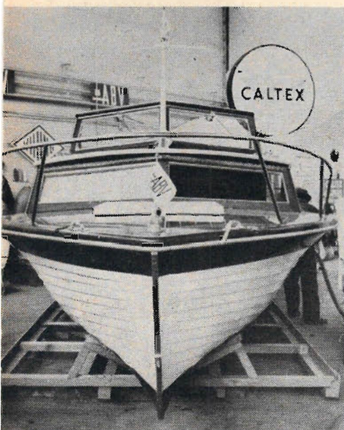
Seamaster utställdes av ABV och har byggts av Ishikawajima-Harima i Tokio. Den är 6,70 m lång och 2,30 m bred och har klinkbyggd bordläggning i mahogny och plywoodbotten. Seamaster levereras med en synnerligen komplett utrustning, som bl a omfattar tankar i rostfritt stål, självlänsar, el-installation, dynor, förtöjningsgods, pentry med kyllåda, vindrutetorkare osv. Pris med utrustning men utan motor 12 950.—. Akterspeglarna är tillverkade med tanke på installation av Aquamatic-motor.
