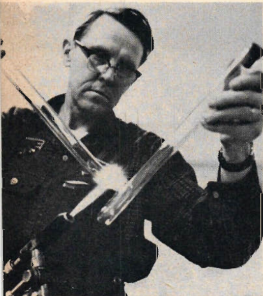
Efter bockningen, på bilden härövan, går rören till karimatan — en speciell ugn — där de värms till 520°C för att få bort spänningar i glaslet.
