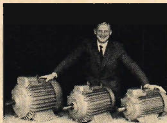
Tre motortyper på vardera 10 hk, 1 500 v/min. Längst tv en motor av den tidigare motorserien RB. Den är 15 år gammal och väger 125 kg. I mitten övergångsstadiet till dagens moderna motor, typ RBS, som är 5 år gammal och väger 92 kg. Längst th en motor av typ RXB, som endast väger 79 kg.
