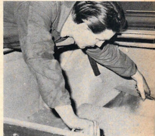
Det övre fästet sitter i allmänhet under mattan i bagageutrymmet och är i regel lätt att komma åt.
