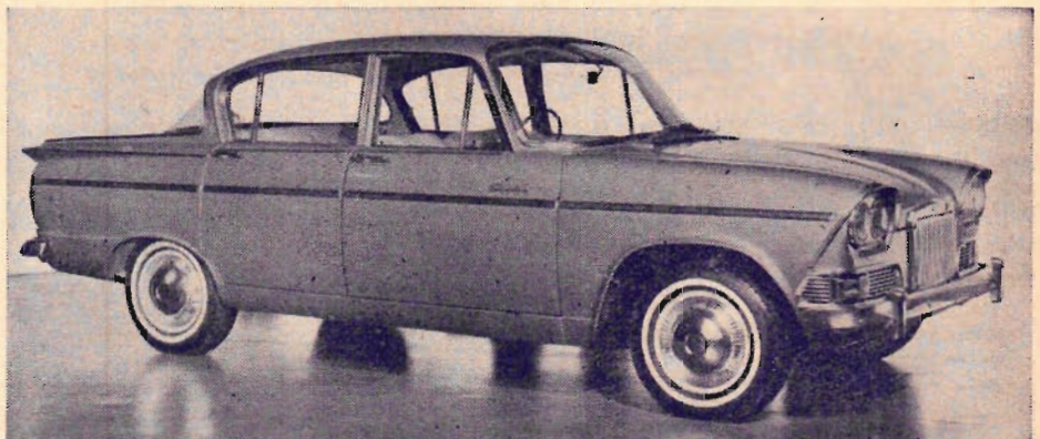
Rootes-koncernen presenterar en ny bilmodell med kompakta ytermått och fina prestanda. Vagnen, som kallas Humber Sceptre — Spiran — har Rootes' sportmotor på 1,6 liter som ger 86 SAE-hästar.
