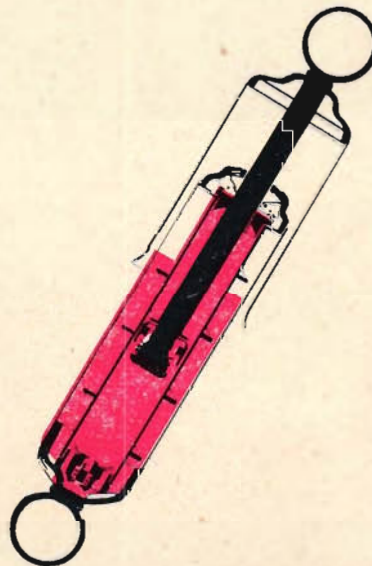
Detta är en stötdämpare av teleskop-typ. I stort består den av två rör som skjuts in i varandra. En kolv arbetar i olja och ger det nödvändiga mottrycket.
