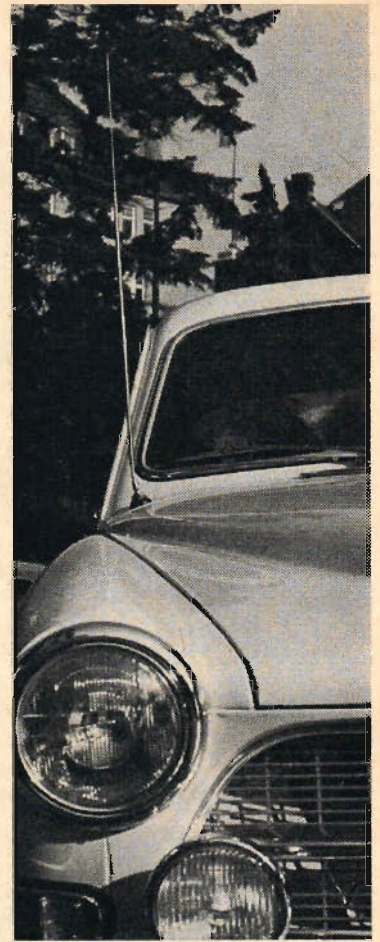
På bilden ovan ses hur antennen skall placeras för att ge bästa mottagning.
