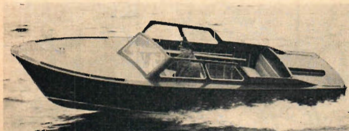
AQUA-FALKEN 5,60x2,10 m. Snabb pass- och vattenskidbåt. Motor: Volvo Penta Aquamatic 80 el 100, fart c:a 28 resp 31 knop.
