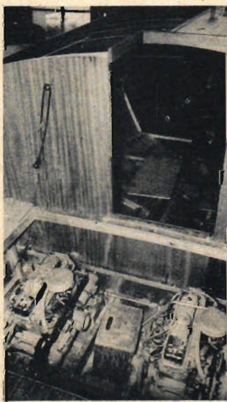
Kabinkryssaren Cabinen har två motorer. I detta fall är det Volvo-Penta BB 70-motorer, som installeras, men båten kan också försees med dieselmotorer.
