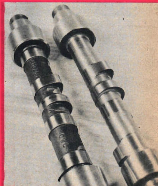
Den omslipade kamaxeln ger både avsevärt större lyfthöjd och öppningstider som är längre.
