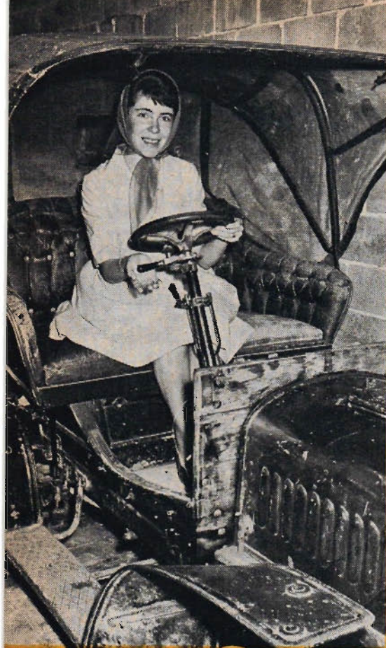
Att rattväxeln inte är någon nyhet bevisas av den här Piccolon som tillverkades i Tyskland 1903. Vagnen är i ö utrustad med ett spett som hindrar den att kana baklänges i branta backar.
