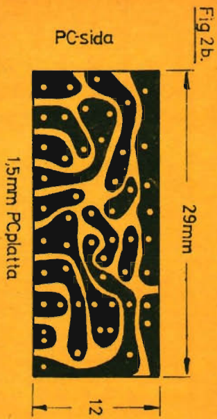
Bilden visar den tryckta kretsen för servistorn. Så installeras servistorn i Micromite- och Duramite-servon. Microperm-motorn har specialfäste för Micromite.
