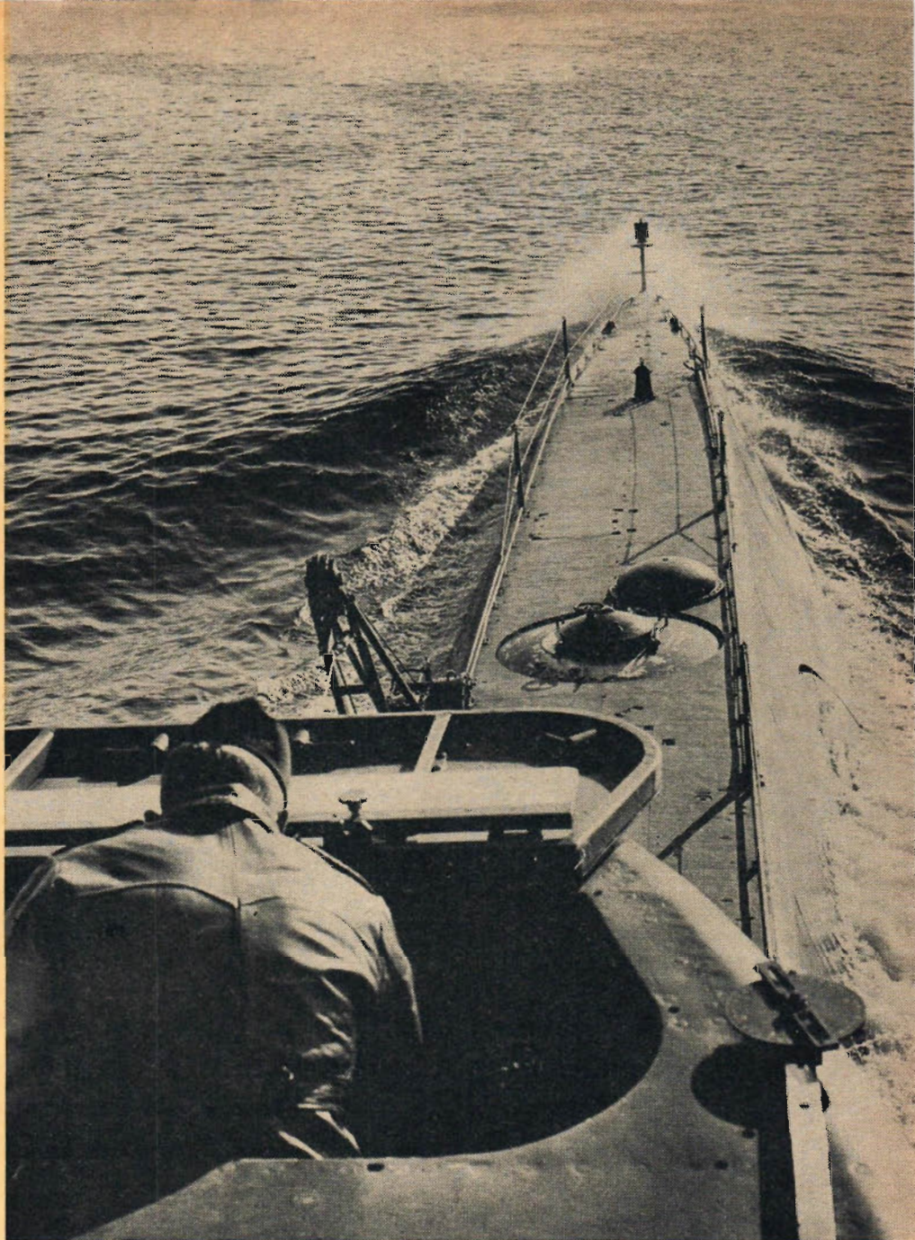
Gripen styr till havs. Nedanför tornet ses förluckan, som även har anslutningsanordningar för ubåtsbärningsfartyget Belos räddningsklocka. Klockan kan anslutas till luckan och gör det möjligt att bärga besättningsmännen i en sjunken ubåt. Till utrustningen hör också den telefonboj, som i ett nödläge stiger upp till ytan och som möjliggör kontakt med och lokalisering av en förolyckad ubåt.
