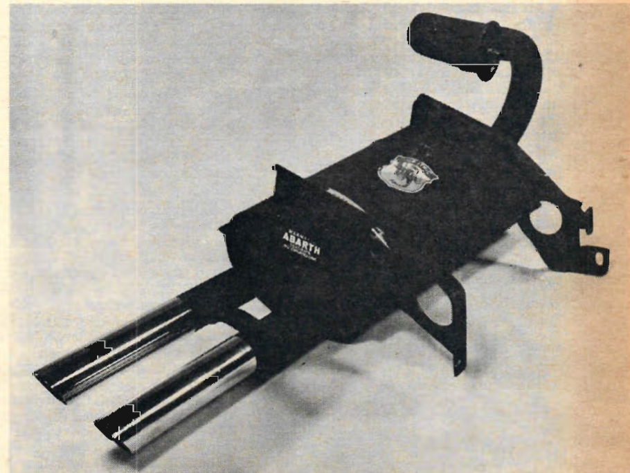
En kvalitetsljuddämpare sparar många slantar i det långa loppet. Abarth har mycket gott rykte härvidlag. För Simca 1 000 kostar denna dämpare 140:—. (AB Tillbehörslagret). Abarth ljuddämpare finns i utföranden till de flesta olika biltyper.
