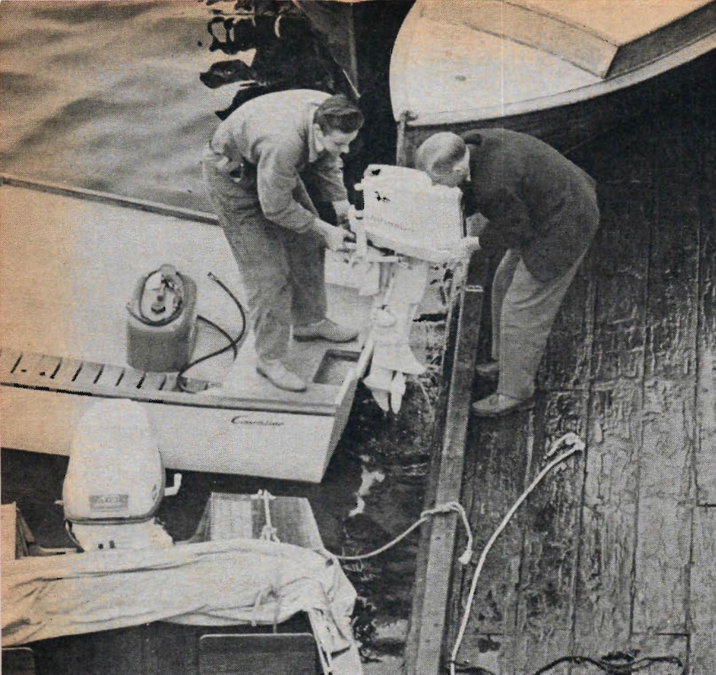
Motorn lyfts upp ur båten. Om det rör sig om en relativt stor motor är det bäst att vara två vid lyftet. Ta det försiktigt. En "badad" motor kräver omgående genomgång av fackman om den skall klara sig utan men. Kontrollera att fjärrreglagekablar, bränsletanksslang osv kopplas loss innan motorn lyfts.
