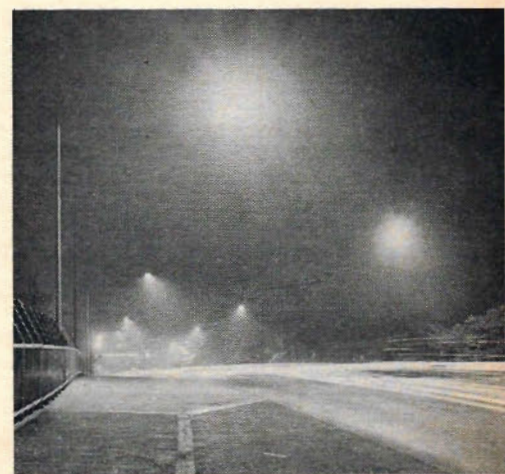
Några hundra meter längre bort kommer Solna stad in med en liten kil och har hängt 250 watts vita kvicksilverlampor sick-sack över vägbanorna.
