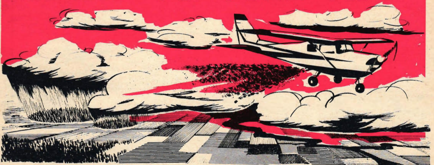
Människan är inte längre slav under vädret. Vi kan bättra på det eller ordna regn på beställning, allt under förutsättning att det finns vissa givna förutsättningar. Teckningen visar hur ett flygplan sprider regnutlösande kristaller över ett moln.
