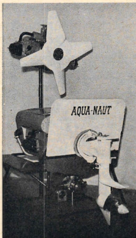
Här är en intressant engelsk marinkonvertering av Volkswagenmotorn. Motorn och den kraftiga kylfläkten är inpackade i en plåtkåpa, som bidrar till effektiv fördelning av kylflödet.
