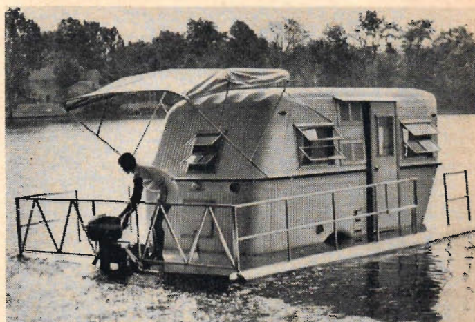
Med en 7,5 hk utombordsmotor kommer amfibiecampingvagnen upp i en fart av 5 knop.
