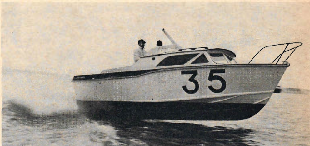
Pacemaker 21 är 6,3 m lång och kan bland sina meriter räkna fina placeringar i havsloppet till Torquay. Den är byggd i plywood med teakdäck, har förstärkt botten med Bertramsteg och har rutor av säkerhetsglas. I kabinen finns två kojor, toalett och pentry. Kan fördes med en eller två Aquamatic. Toppfart med två Aquamatic 34 knop. Priset ligger mellan 32 000 och 43 500 kr beroende på motorval.
