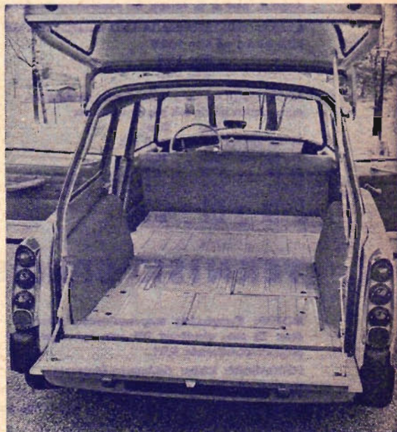
Med baksätet och bakstolarna nedfällda får man ett lastgolv med drygt två meters längd. Takets bakre kant är inte neddragen, varför man kan utnyttja hela takhöjden.
