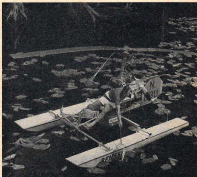
Tack vare att Bensen Gyrokofter är försedd med pontoner kan man landa både på vatten och land.
