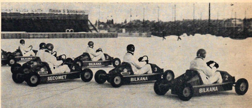
Vid den stora träningskörningen på Rocklunda Isstadion i Västerås kördes varannan bil med dubbar och varannan utan. Ett moment omfattade gemensam start, och när bilarna fått upp farten skulle de stannas på kortaste möjliga sträcka. De dubbade bilarna stannade snabbast. (Bilkana-vagnarna är odubbade).
