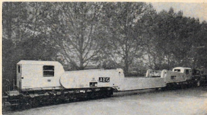
Möjligheter finns att byta ut järnvägshjulen mot gummihjul för övergång till landsvägstransport. Vagnens bärkraft är 200 ton.
