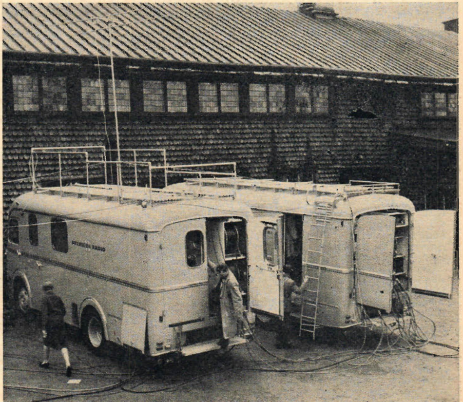
Vid större och komplicerade sändningar utanför ordinarie sändningslokal används OB-bussarna. Bussarna innehåller fullständigt kontrollrum där under Trekampen de lokala producenterna fanns.
