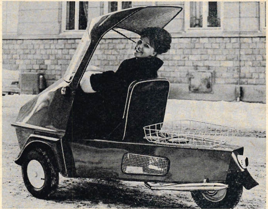
Den nya modellen av Shopper har fått front och överbyggnad i glasfiberarmerad plast.
