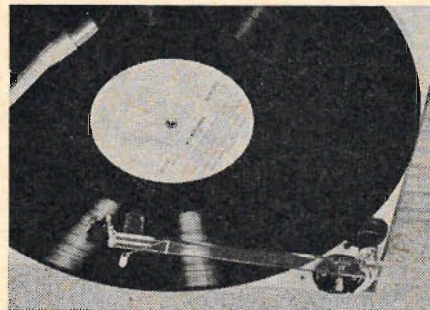
På denna bild är Dust Bug festsatt på en HMV-skivspelare. I ett fall som detta hade det varit bättre om hållaren satts på en utbyggnad på skivspelarens sida.
