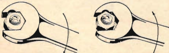
När polykombnyckeln en gång är påsatt är det bara att skruva precis som man arbetar med en spärrnyckel.
