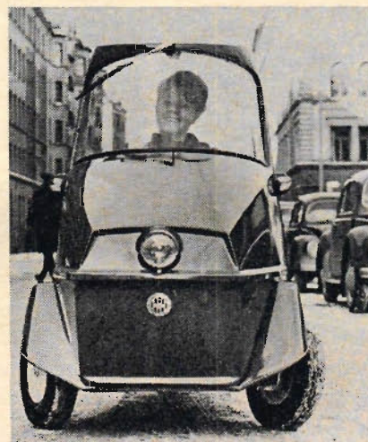
Utformningen är mer modern och sikten bättre än tidigare. Skivbromsar på alla hjulen.
