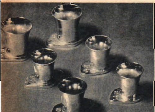
Rampipes är tillbehör som kan intressera den trimningskunnige bilisten. De här är gjorda för SU-förgasare och finns i storlekarna 1/4", 1/2" och 3/4". Pris per par 60 kr.
