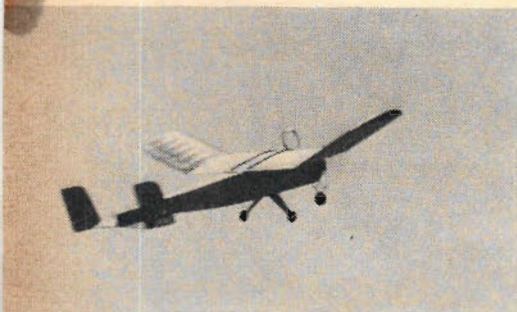
Det lilla obemannade skogsbevakningsplanet stiger. Spännvidden är 185 cm och planet kan stiga till 3 000 m höjd med en instrumentlast på 1,5 kg.
