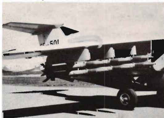
SAAB 105, försedd med tolv 13,5 cm attackraketer
