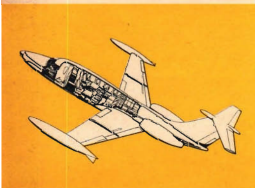
Hansa har ett mycket karakteristiskt utseende med omvänd pilform på vingarna, högt placerad stabilisator och stora vingtankar. Spännvidden är 14,5 m och landningssträckan är 1 160 m.
