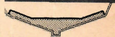
Selco har byggt en 27 fot lång kabin-kryssare i glasfiberarmerad plast. Båten har försetts med dubbel botten och räknas som osänkbar.
