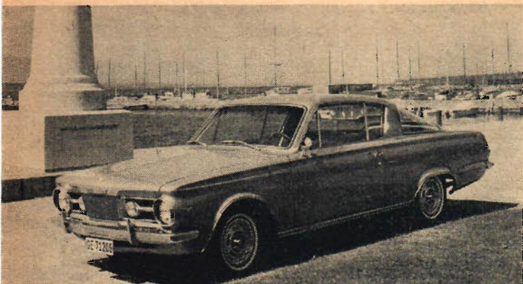
Barracuda är Chryslers svar på Fords Mustang. Den har bl a en långsluttande bakruta, som är den största som hittills funnits i en seriebyggd bil. Fyrväxlad, hellsynkroniserad låda med golvspak och individuella framstolar är standard.
