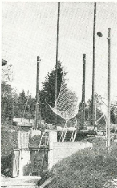
Katapultstolbana för prov av tryckkammare
