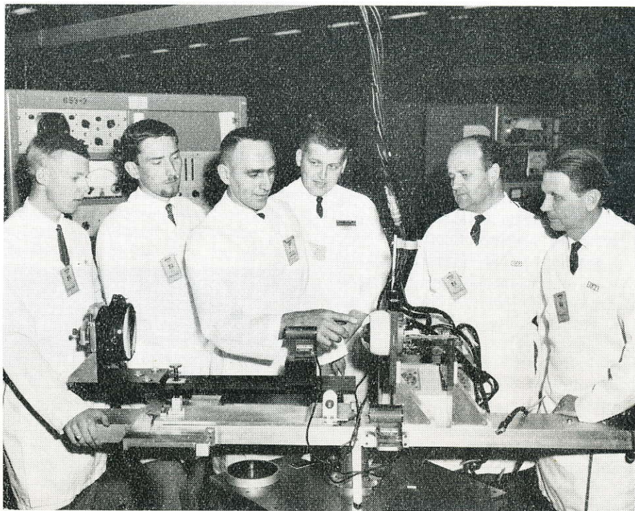
Mr Frank Saluta, 3:e fr. v. biträdd av Mr Walter Groome Jr till höger om honom visar här fr. v. Lars Jacobsson, Bo Hellström, Bertil Wadsten och Arne Rydeborg hur man provar och testar ett sökarhuvud till Sidewinder.
