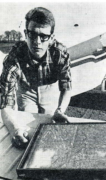
Författaren med ett av honom själv konstrollerat enhandsmanövrerat kartbord.
