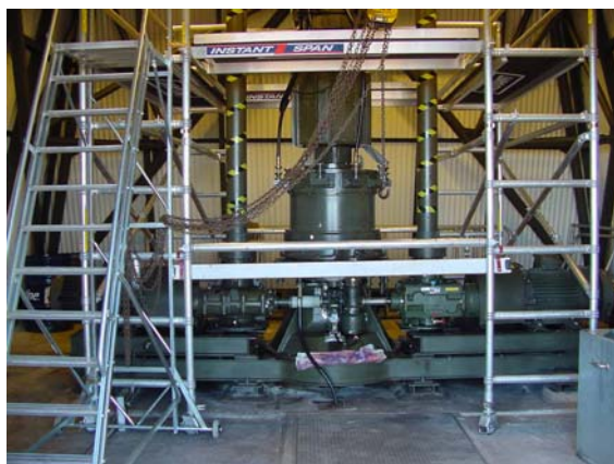
De två vridmotorerna med sina drivaxlar (de med svart/gul tape).
