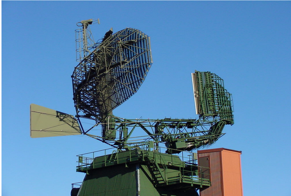
Antennreflektor och "fena" t.v. med primärstrålarenhet t.h. Foto K-G Andersson
