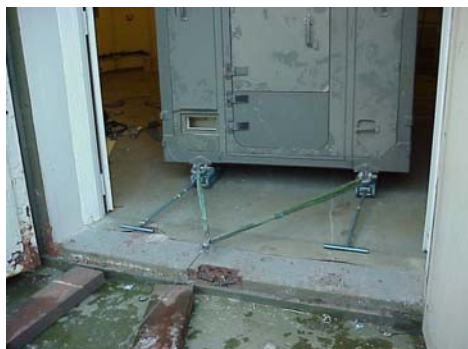
”Multitrans” bestående av draganordning och styrmöjlighet.
