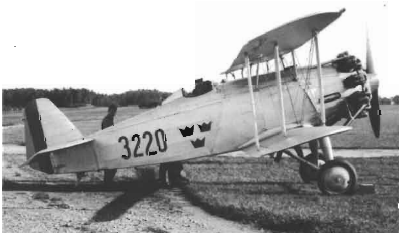
Den av Svenska Aero byggda J6B JAKTFALKEN var försedd med en Bristol "Jupiter VIII" på 500 hk.
