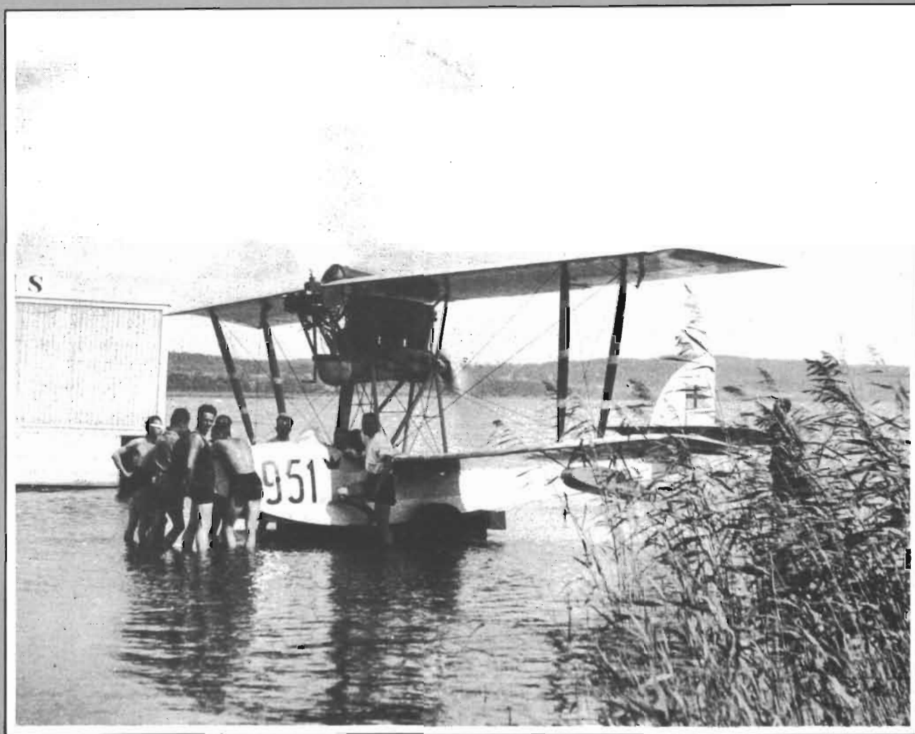
Jaktflygbåt typ MACH I - M7, med en 240 hk "Isotta Fraschini"-motor.
