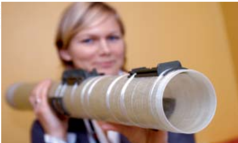
Polymerbaserade (plast) kompositmaterial kombinerar hög styvhet och hållfasthet med låg vikt och goda långtidsegenskaper. Materialet används bland annat till olika typer av granat- och eldrör; rotorblad, hjälmar, containrar och skydd i fordon.
