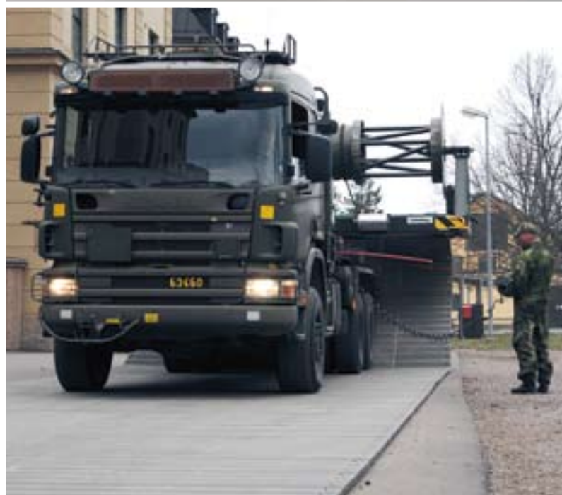
Två personer krävs för att hantera systemet, en som kör och en som hanterar hydrauliken och dirigerar föraren.
