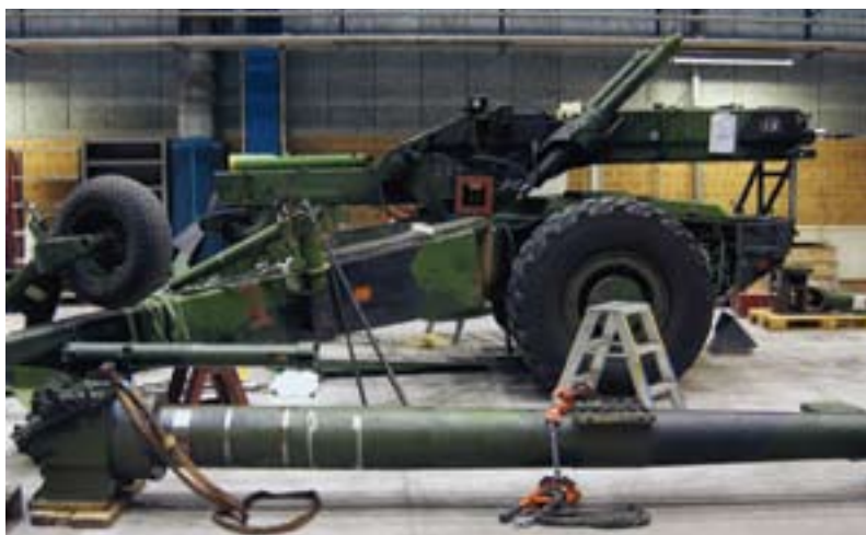
Gamla Haubits 77B monteras ned och får i vissa delar fortsatt tjänstgöring i Archersystemet.
