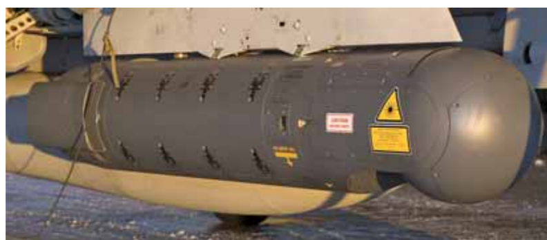
Målutpekaren, även kallad LDP, Laser designator pod, är precisionsvapensystemets andra vitala del. Dess uppgift är främst att peka ut fasta och rörliga mål med hjälp av laser. Dessa strålar guidar sedan GBU-12-bomben mot det specifika målet. Målutpekaren innehåller bland annat en målpekarlaser, lasermarkerare för markering av mål till markförband, en övningslaser, en avancerad videokamera och en IR-sensor som känner av temperaturskillnader mellan målet och dess omgivning.
