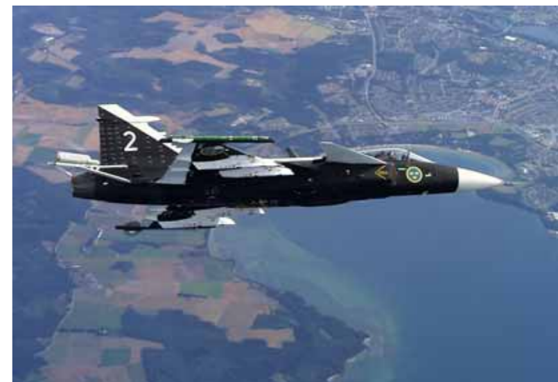
Proverksamheten är alltid en av grundstenarna i utvecklingen av flygplan. Här ett tidigt spinprov, med spinnskärm monterad på Gripen.
