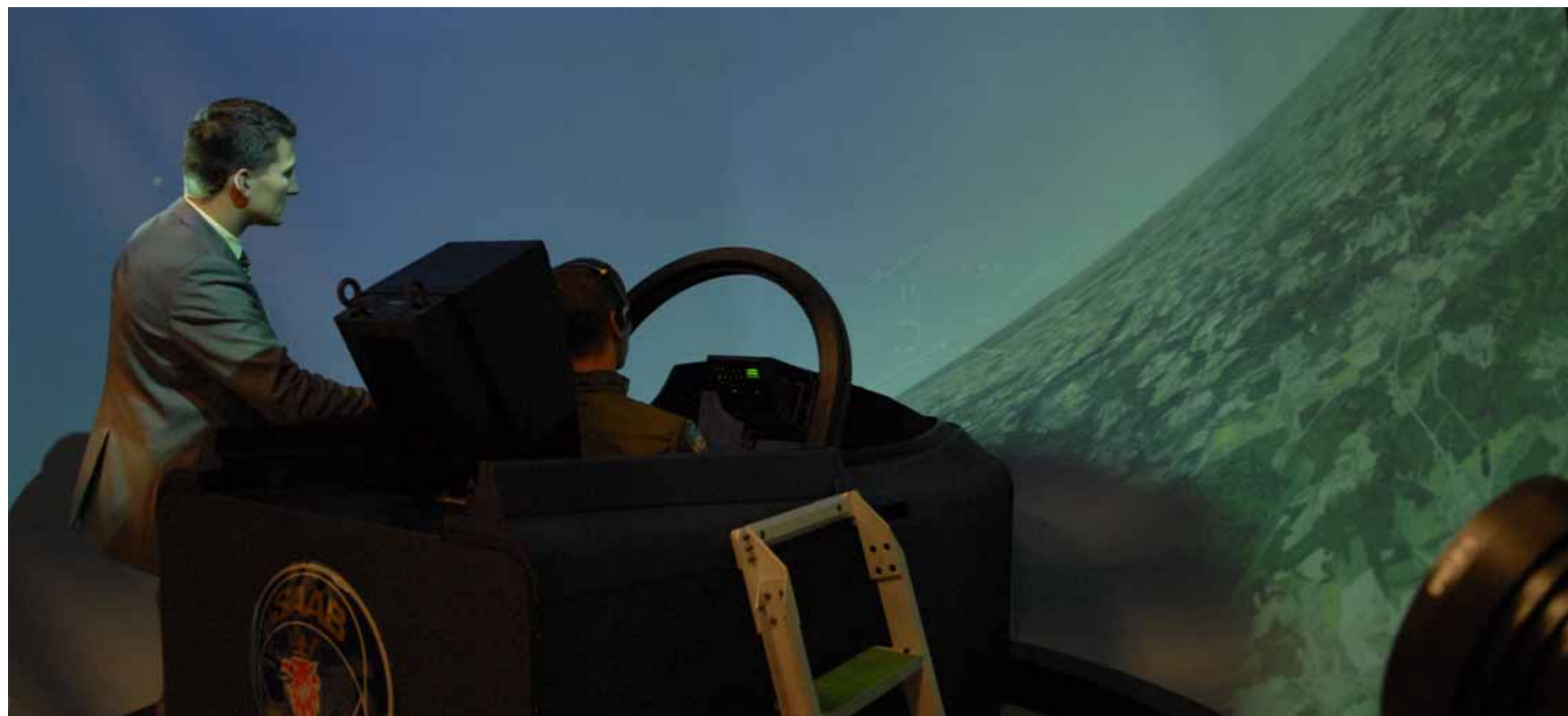
Simulatorsystemet Petras åtta projektorer ger piloten en sfärisk omvärldsbild.
