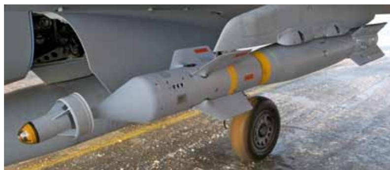
Gripens nya precisionsvapensystem består bland annat av bomben GBU-12. Den väger 227 kilo och är försedd med laserföljare, styrenhet och vingar. Integreringen av GBU-12 på Gripen har varit förhållandevis enkel. Upphängningen sker på balkar av Nato-typ.
