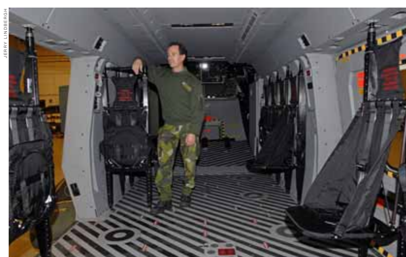
Helikopter 14, det vill säga den svenska versionen av helikoptern NH90, har en förhöjd kabin. 24 extra centimeter ger en ståhöjd på 182 centimeter och 2,5 kubikmeter extra lastutrymme.
