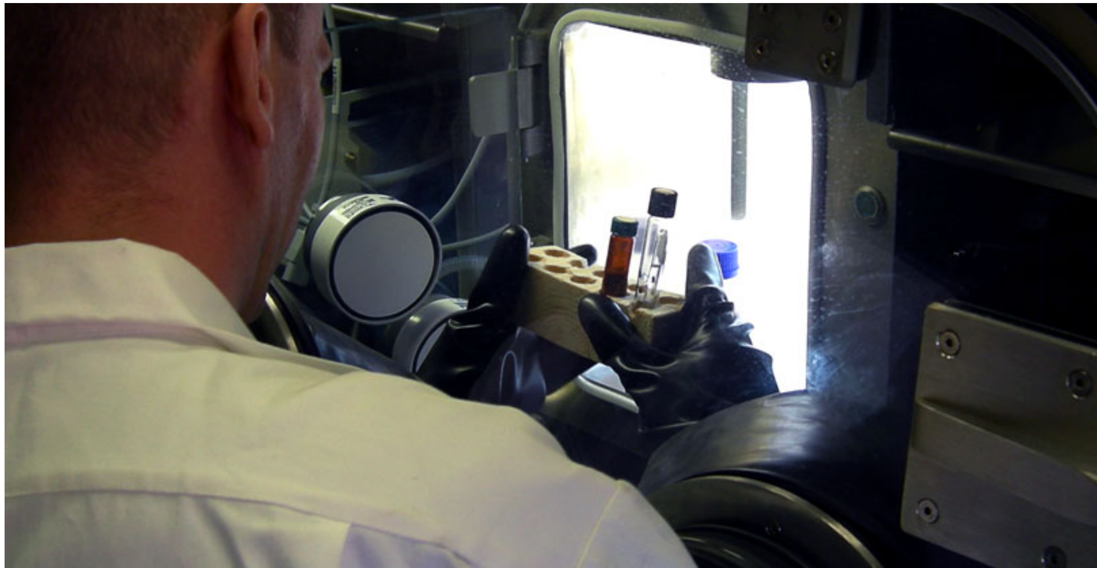
Genom en lucka i containerväggen lämnas de prov som ska analyseras. Mellan luckan och laboratoriet finns en luftsluss för ökad säkerhet.
