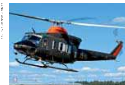
Helikopter 11. Augusta Bell 412HP. Max startvikt 5,4 ton. 1994-2004. Fem i armén. Från början ambulanstransport i samarbete med landstingen, numera trupptransport.
