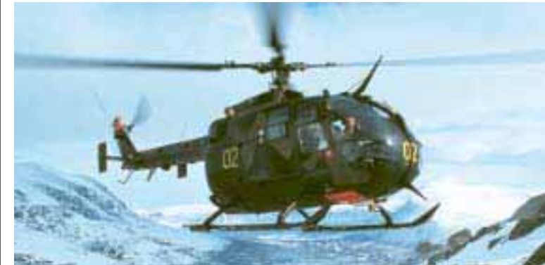
Helikopter 9. MBB BO 105 CBS. Max startvikt 2,5 ton. 1985-2009. 21 i armén, 4 i flygvapnet. Var beväpnad för pansarvärn fram till år 2000. Även transport av trupp och materiel. Väntas avvecklad 2009.
