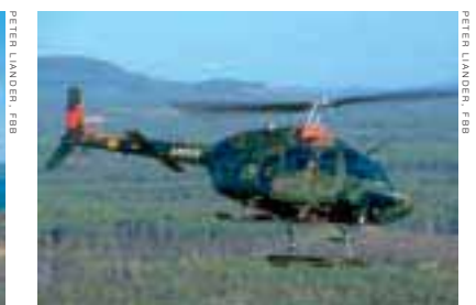
Helikopter 6. Augusta Bell 206 A. Max startvikt 1,3 ton. 1968-2004. 22 i armén, 11 i marinen.
