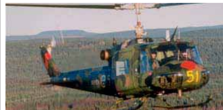
Helikopter 3. Augusta Bell 204B. Max startvikt 4,3 ton. 1962-2001. 22 i armén, 11 i marinen. Materiel-, trupp- och sjuktransport samt brandbekämpning.
