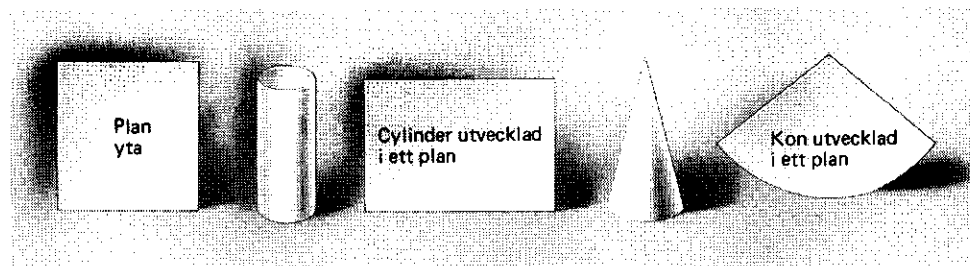
Bild 5.1 Konens och cylinderns utvecklade ytor
