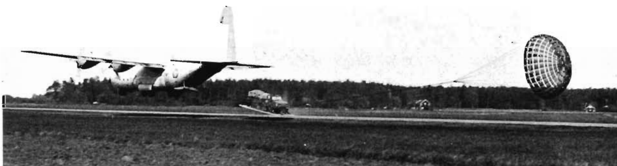
Fällning av bandvagn. Lastens totalvikt: 5 650 kg.
