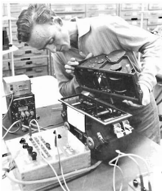
Panoramakamera för flygfotografering kontrolleras elektriskt vid CVA.
