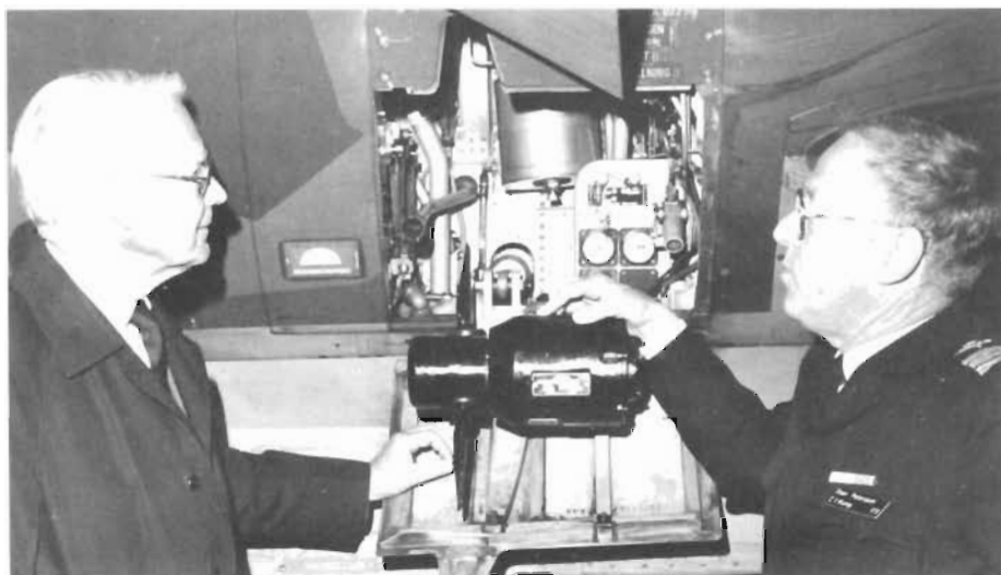
Kapten Sten Petersson visar TIFF redaktör hur det utfällbara nödeffektaggregatet fungerar på Viggen
