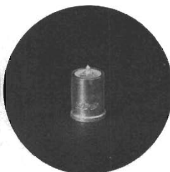
Variabel kapacitans dioder SVC 11—22 med min arb frekv. 25—85 G Hz övergångskapacitans 2,1 till 1,4 pF.
