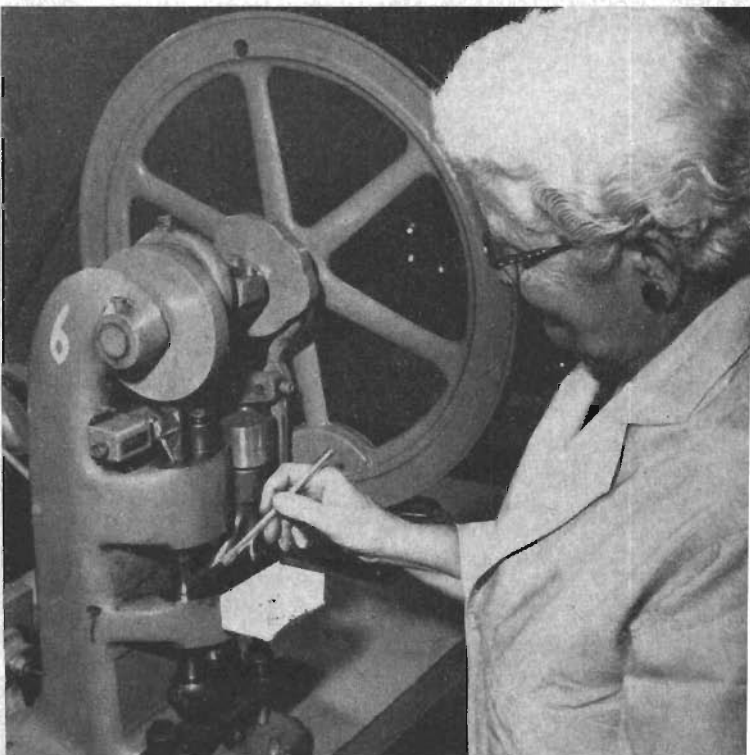
Fig. 1 Ferritkärnorna, av vilka miljontals kan ingå i en datamaskins minnesenhet, träs upp på tunna, isolerade koppartrådar, som tillsammans bildar en »matris», sammanhållen av en aluminiumram. Bilden visar monteringsmomentet vid RCA:s laboratorium i Needham Heights, USA.
