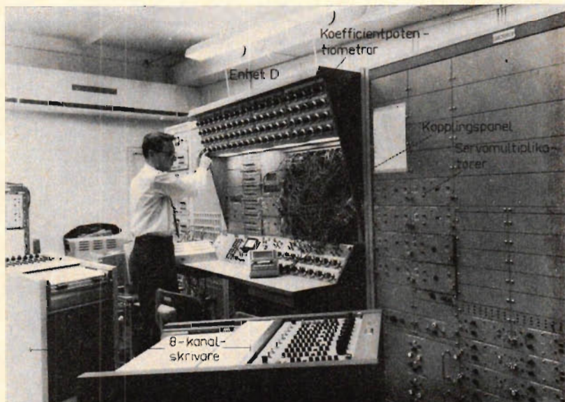
Fig. 4 Enhet D med koefficientpotentiometrar och kopplingspanel. I förgrunden en 8-kanal-skrivare. Plug-in-enheter till höger är servomultiplikatorer.
