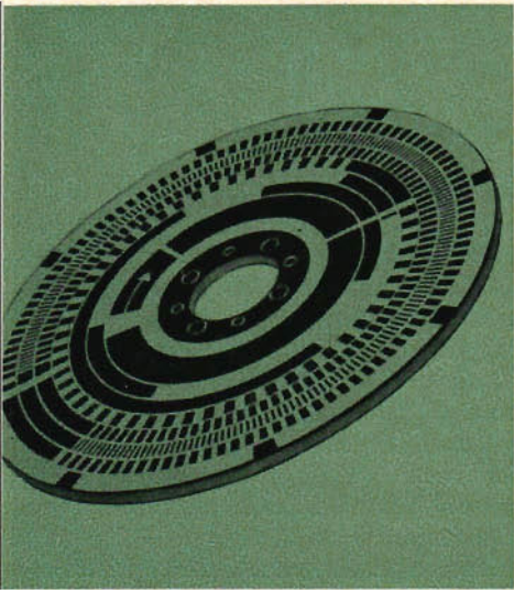
Fig. 8 Exempel på kontaktbanor för omkopplarkontakt tillverkad i tryckt ledningsdragning. (Technograph.)
