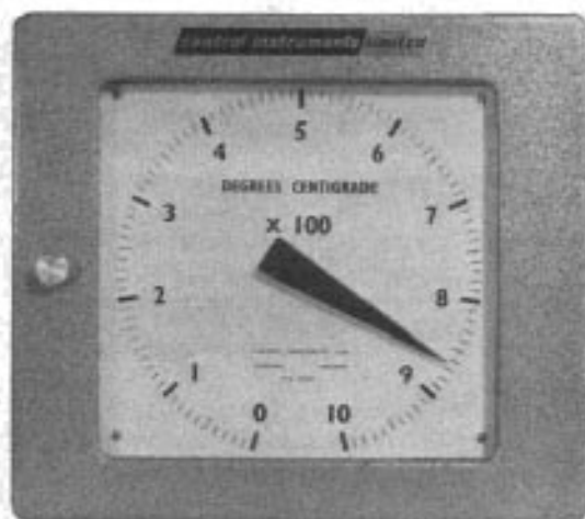
Rundskaleindikator med 360° inställning och ca 500 mm skallängd.
