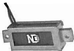
Likströms miniatyrmagnet Storlek: längd från 13—40 mm Slaglängd: från 0,5—6 mm
