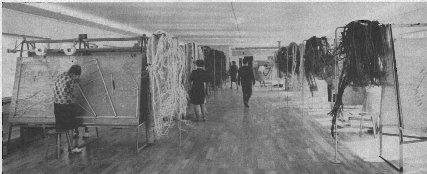
Vid Ingenjörfirman K A Wikings nya fabrik i Skänninge är ett 60-tal anställda sysselsatta med att sy kabelkretsar på beställning.
