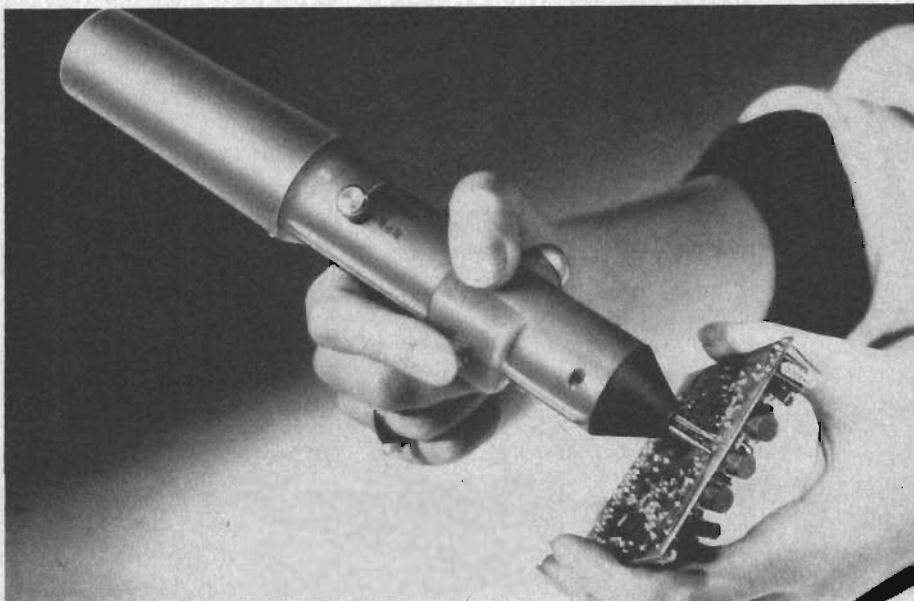
Fig. 6 Enkel transistor- och diodprovare, typ »Diatester», avsedd för provning av transistorer och dioder, inlödda i kretskort. Provningen kan utföras utan att komponenten lödes bort. (Tillverkare: Sercel, Frankrike.)
