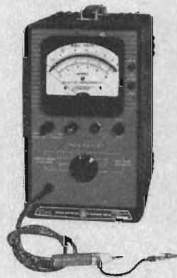
Modell 340 100 kHz—700 MHz 0,3 mV—3 V sant eff.-värde Noggrannhet: 4 % Toppfaktor 100—3 1 Megohm—25 K \Omega Pris: 4.825.—
