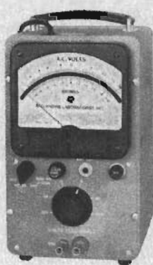
Modell 300 H 10 Hz—1 MHz 30 \mu V—300 V Noggrannhet: 2 % Medelvärdeskännande 2 Megohm 40 db bredbandsförstärkare Pris: 1.600.—
