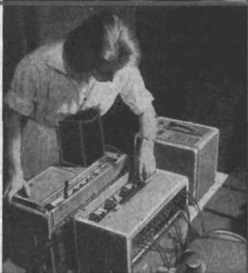
OSCILLOPORT ljusstråleosillograf för 5 - 10 förlopp, i provrum för elmotorer.
