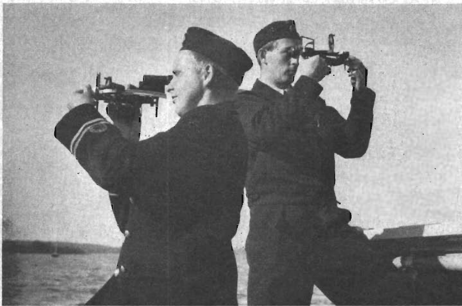
Fig. 1 Positionsbestämning genom sextantvinkelmätning, en metod som var allenaordande vid positionsbestämning för endast några få år sedan. Med denna metod kan man dock endast uppnå tillfredsställande noggrannhet vid mätningar inomskärs och mycket nära kusten.
