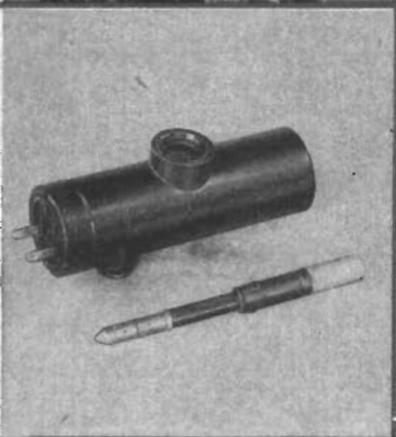
MÄTSLINGA OCH MÄTPOLE för ljusstråleosillografer, effektivt frekvensområde 10 kHz.
