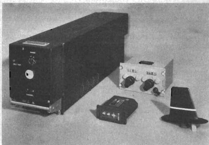
Fig. 2 Marconis elektroniska avståndsmätare för flygplan. Fr.v. sändar- och mottagar-enhet, digitalindikator på vilken det uppmätta avståndet indikeras, bakom digitalindikatorn den kontrollenhet på vilken frekvensen ställs in. Längst t.h. utrustningens antenn.
