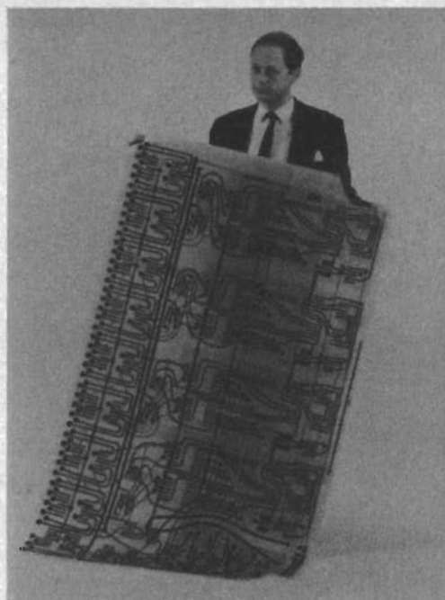
En av artikelförfattarna, civilingenjör Bertil Weyde, visar här upp en klichéritning i skala 10:1 för ett kretskort avsett för integrerade halvledarkretsar.
