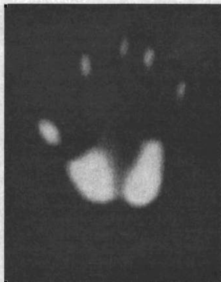
Fig. 4 Här ser värmekameran något som det mänskliga ögat inte kan se. Någon lade sin hand på en pappskiva och tog bort den igen. På bildröret ser man värmebilden, som dröjer kvar på pappskivan.
