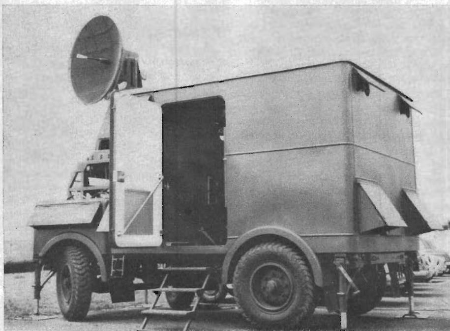
Fig. 1 Väderradarstation i mobilutförande, typ Meteor 200-1 S. Den visade radarn tillverkas av Selenia Industrie Elettroniche Associate SpA, Italien (svensk representant: Magnetic AB). Anläggningen arbetar på frekvensen 9375 MHz, effekten är 200 kW, pulstid 0,5 eller 3 \mu s.
