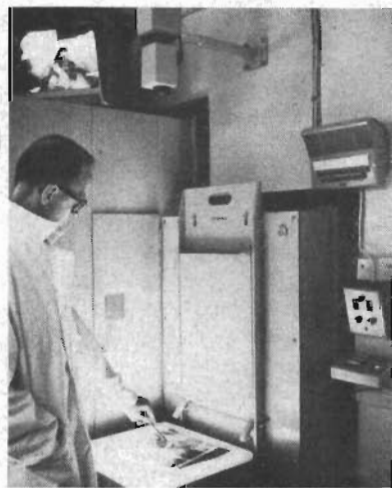
TV-kameran är inriktad mot röntgenbilden, som placerats på ett ljusbord för granskning (t.v.). Samtidigt överförs bilden till en TV-mottagare där kirurgen kan studera den och jämföra den med tidigare tagna röntgenplåtar (t.h.).
