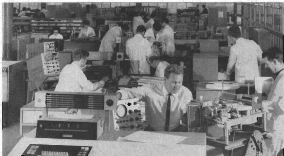
Fig. 1 Interiör från IBM:s fabrik i Greenock i Skottland, där man bl.a. tillverkar den nya datamaskinen IBM 1130. I förgrunden ses centralenheten och manöverpulpeten till IBM 1130. I den skrivbordsliknande enheten finns även plats för ett skivminne med utbytbar skiva.
