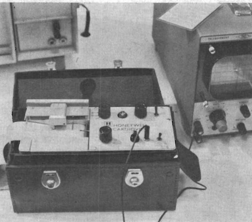
Fig. 2 Liten portabel elektrokardiograf, typ Cardioview, som tillverkas av Honeywell. Dimensionerna är 28,4×11,4×17,8 cm, vikt 4,5 kg. (Foto: Thore Rösnes.)
