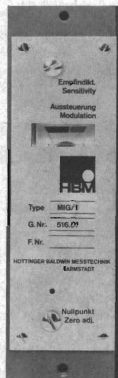
Förstärkare i MIG-systemet
